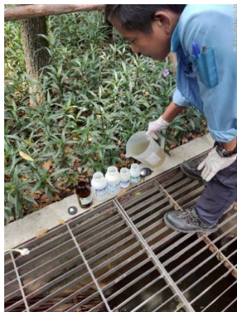
รูปที่ 3.5.5-1 การเก็บตัวอย่างน้ำของระบบบำบัดน้ำเสีย
